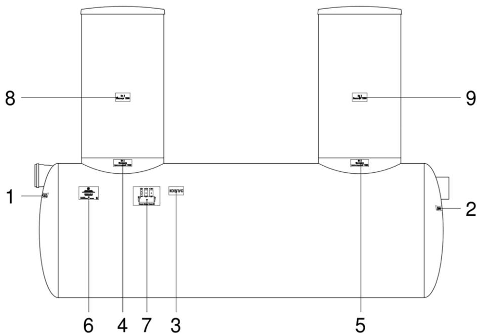
Рисунок 4 – Схема маркировки песконефтеуловителя Argel P
